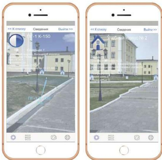
Программное обеспечение позволяет накладывать на изображение с камеры мобильного устройства не существующие в действительности маркеры, указывающие расположение источников противопожарного водоснабжения, а также иной информации, необходимой при организации тушения пожаров.
